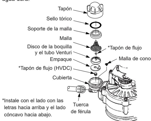
**IMPORTANTE:** Asegúrese de que el orificio pequeño del empaque se centre directamente sobre el orificio pequeño de la cubierta de la boquilla y del tubo Venturi. Asegúrese de que los números estén mirando hacia arriba.
